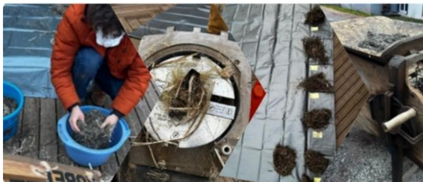
Figure 19 Séquence de test de transformation des fibres : comparaison de diverses méthodes et niveaux de transformation, test de densité des fibres obtenues en conditions proches d'une compression manuelle dans un caisson isolant
