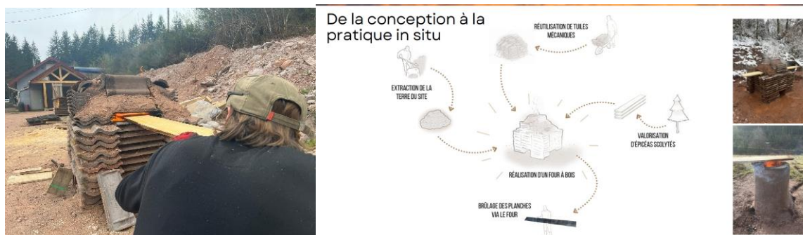
Figure 15 Prototype de four lowtech de brûlage maîtrisé du bois
