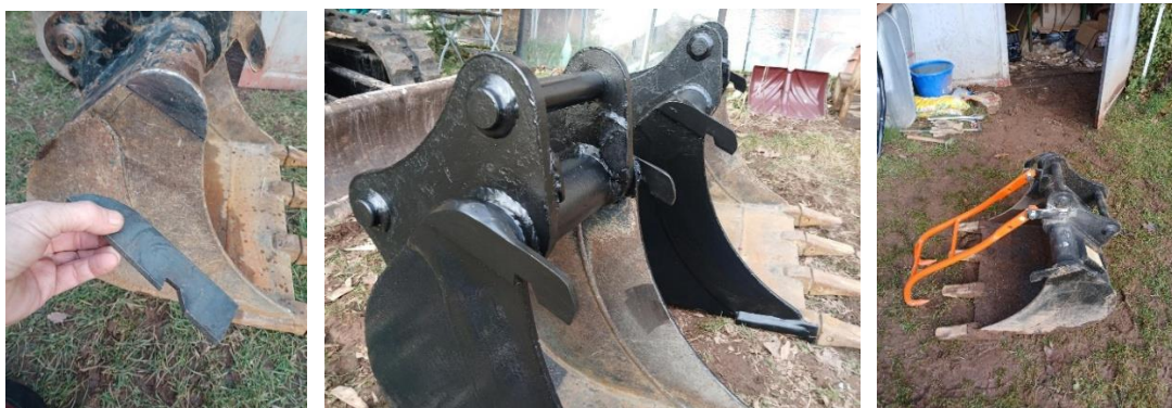
Figure 11 Exemple d'outils modifiés pour répondre aux besoins spécifiques d'une mini-exploitation (ici un godet modifié avec une pince à grume automatique pour les manipulations à la scierie de petits volumes de bois, à défaut d'un grappin hydraulique plus coûteux et surdimensionné pour le besoin).
